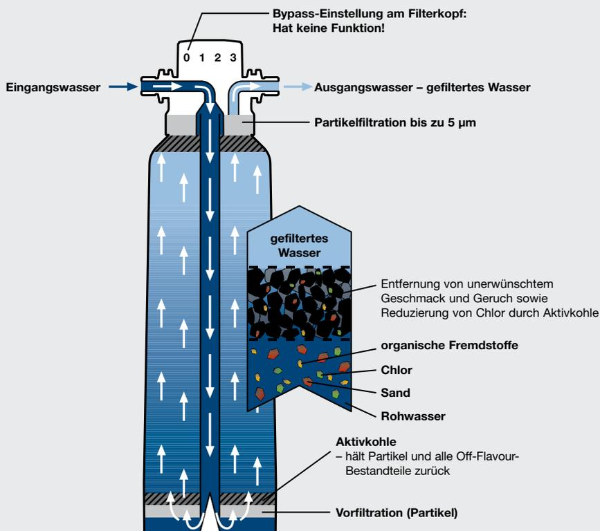
Aufbau einer BWT besttaste Filterkerze
